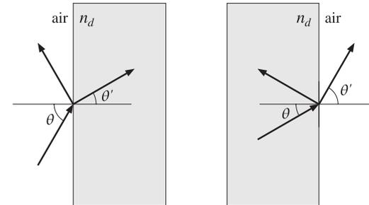
Fig. 7.4.1 Air-dielectric interfaces.
