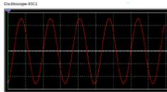
Unrectified AC Voltage Sinusoid
