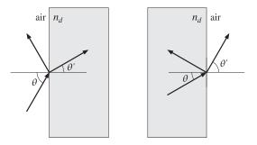
Fig. 7.4.1 Air-dielectric interfaces.
