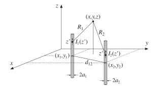
Fig. 25.4.1 Array of two linear antennas.
