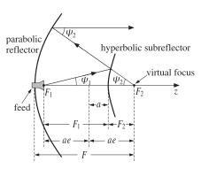
Fig. 21.11.1 Cassegrain dual-reflector antenna.
