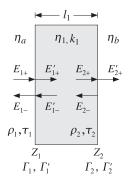
Fig. 5.4.1 Single dielectric slab.
