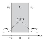
Fig. 9.11.1 Dielectric slab waveguide.
