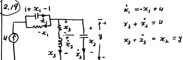
$$\dot{x} = \begin{bmatrix} -1 & 0 & 0 \\ 0 & 0 & -1 \\ 0 & 1 & -1 \end{bmatrix} x + \begin{bmatrix} 1 \\ 0 \\ 0 \end{bmatrix} u \quad y = [0 \ 1 \ 0] x$$
